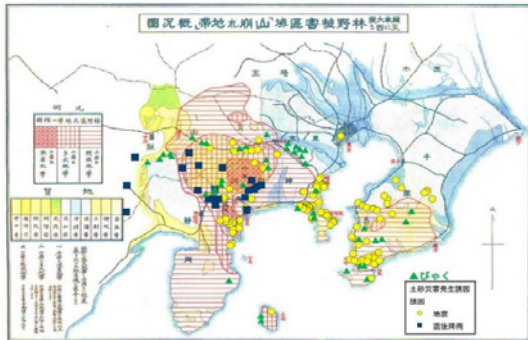
図 1 関東地震による林野被害区域「山崩れ地帯」概況図と関東地震による土砂災害地点(三宅島を除く)(井上, 2013 に▲びやくの地点を追記)
