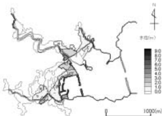
図-7 浸水深（防波堤完成時）
