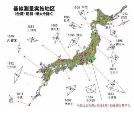
図1 基線測量の実施地区 Fig. 1 Distribution map for Baseline Measurement Survey fields.
