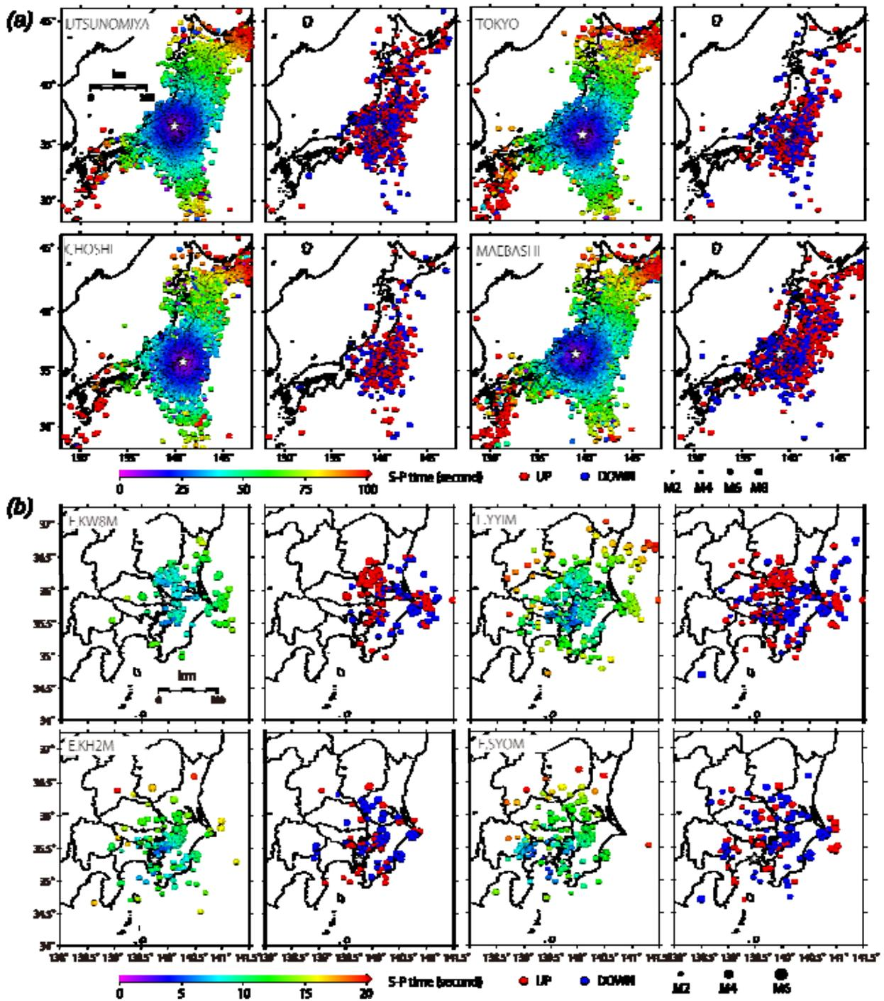
図 2. (a) 宇都宮，東京，銚子，前橋の気象庁観測点における（左）S-P 時間，（右）初動（赤；上方動，青；下方動）を気象庁カタログ（1923 年 1 月 14 日～2011 年 12 月 31 日）の震央にプロットしたもの．星印はそれぞれの観測点の位置を表す．(b) 柏（E.KW8M），本郷（E.YYIM; 弥生（東京大学地震研究所構内）），横須賀（E.KH2M；第二海堡）ならびに鎌倉震研（E.SYOM）における（左）S-P 時間，（右）初動（赤；上方動，青；下方動）の分布を MeSO-net 検測値から決定した震央（2008 年 4 月 1 日～2014 年 7 月 10 日）にプロットしたもの．
